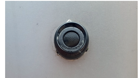
Verzonken montage van een sensor/hulsmontage op een verticaal oppervlak.
